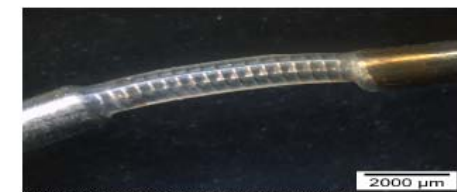
Abbildung 29: Gebrauchte Membran in 70facher Vergrößerung
